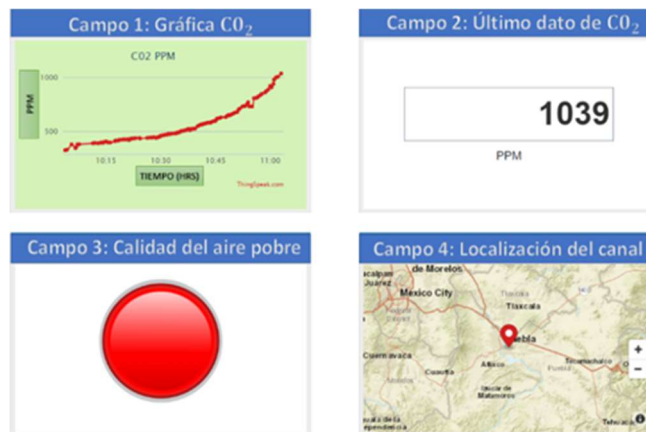
Fig. 5. Dashboard generada en el software ThingSpeak.
